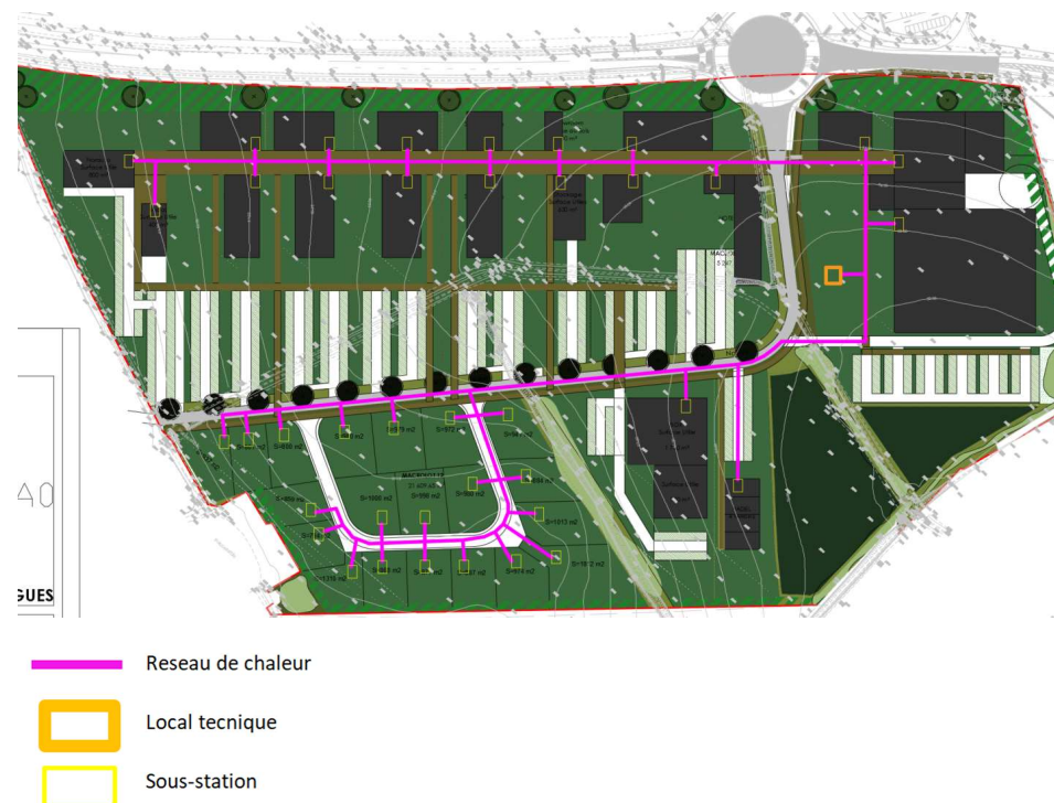
Réseau de chaleur pour tous les bâtiments de la ZAE
